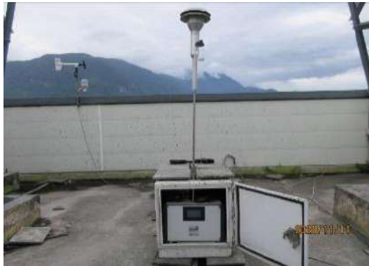
揚塵預警通報系統-PM 10 自動監測站
