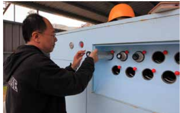
■ 儲氫罐放入充氫機，即可提供移動載具使用。
